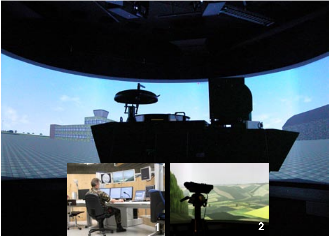
Elektronische Schiessausbildungsanlage für den Schützenpanzer 2000 (ELSA Spz 2000). Bedienungs- und Überwachungsstation (1), Zielvermessungs- und Beobachtungsausrüstung (2).
