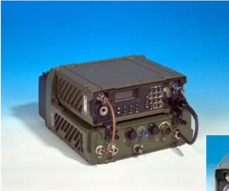
Funksystem SE-240, Leistungstufe 125 Watt
